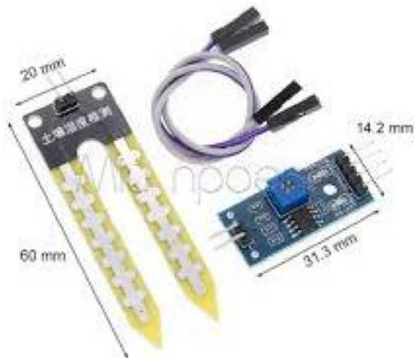
Рисунок 2.19-Габаритні розміри датчика вологості ґрунту YL-69
