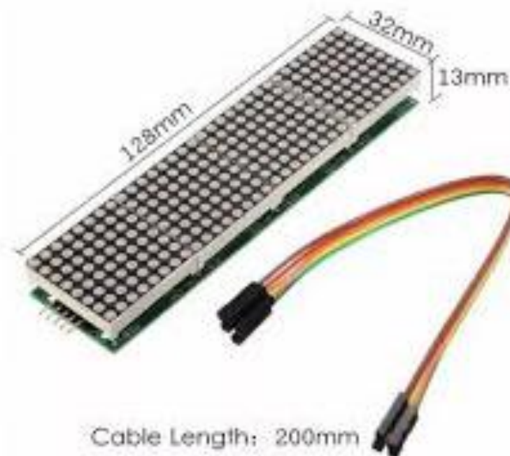
Рисунок 2.17-Габаритні розміри матричного модуля MAX7219
