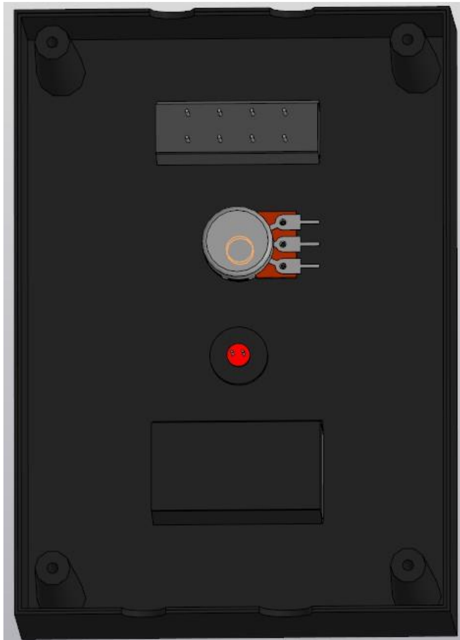
Рисунок Б.5 – 3D модель пристрою, верхня кришка знизу
