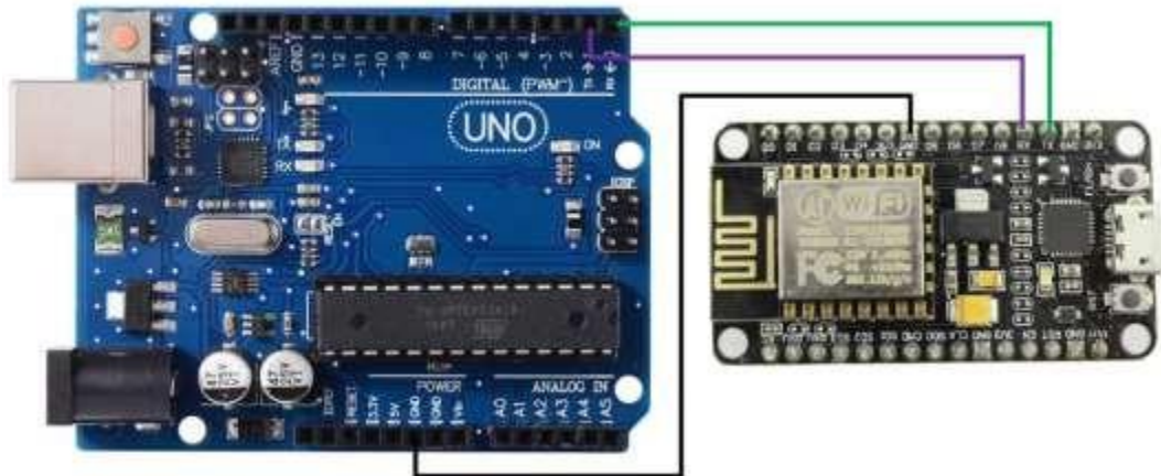
Рисунок 2.18. З'єднання між вузлом та Arduino
