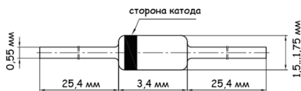
Рисунок 2.8 – Габаритні розміри діода BZX55
