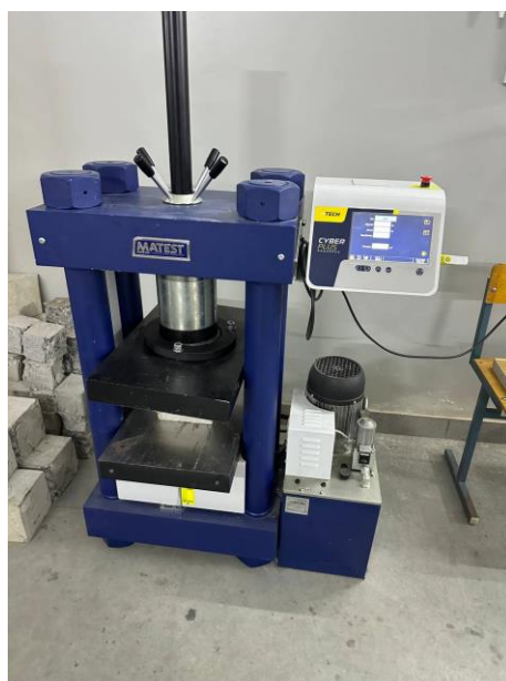
Рисунок 3.7 – Випробувальний прес MATEST з контролером Cyber-Plus Progress
