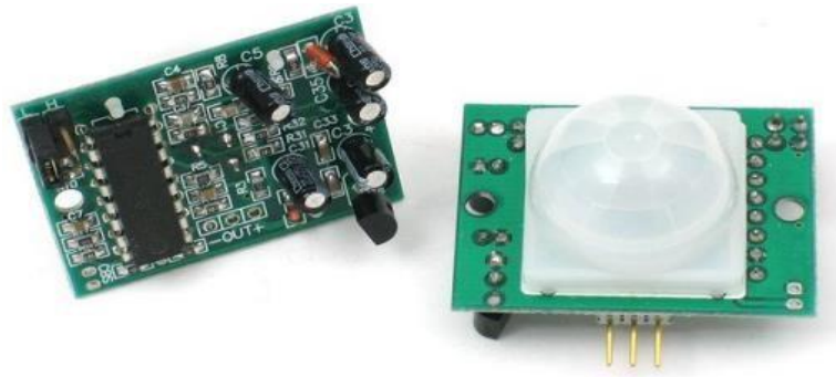
Рисунок 2.7. Датчик руху PIR.
