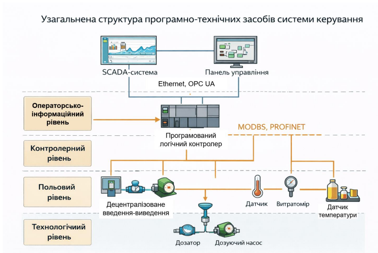
Рисунок 1.2 – Узагальнена структура програмно-технічних засобів системи керування
