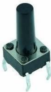
Рисунок 2.8 – Зовнішній вигляд кнопки тактової KLS7-TS6601-13.0-180
