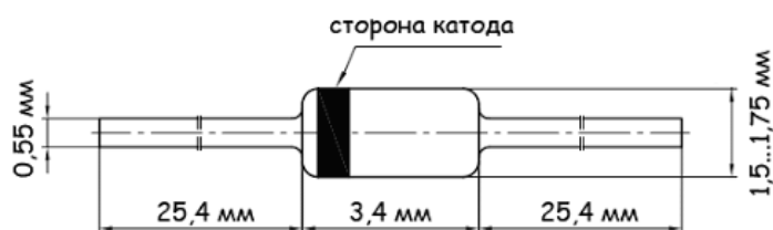
Рисунок 2.5 – Габаритні розміри діода 1N4007
