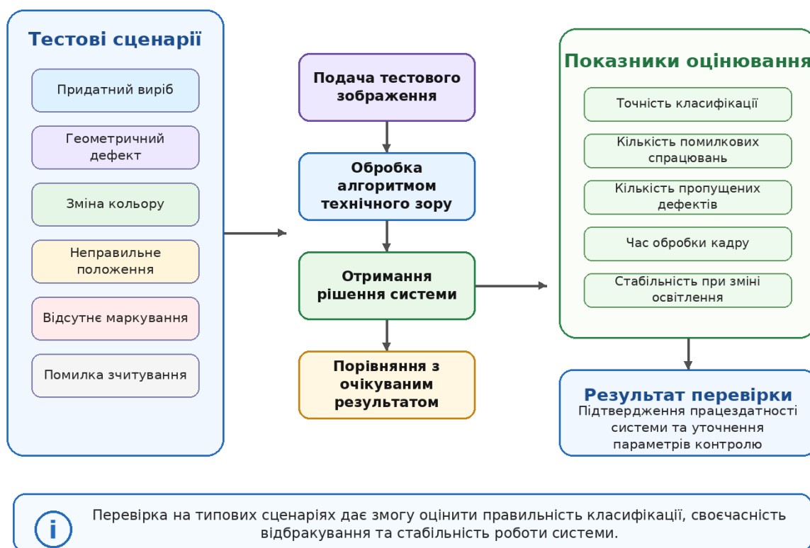
Рисунок 3.4 – Узагальнена схема перевірки роботи системи на тестових сценаріях
