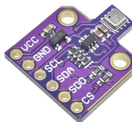
Рисунок 2.6 – Вигляд датчика BME680
