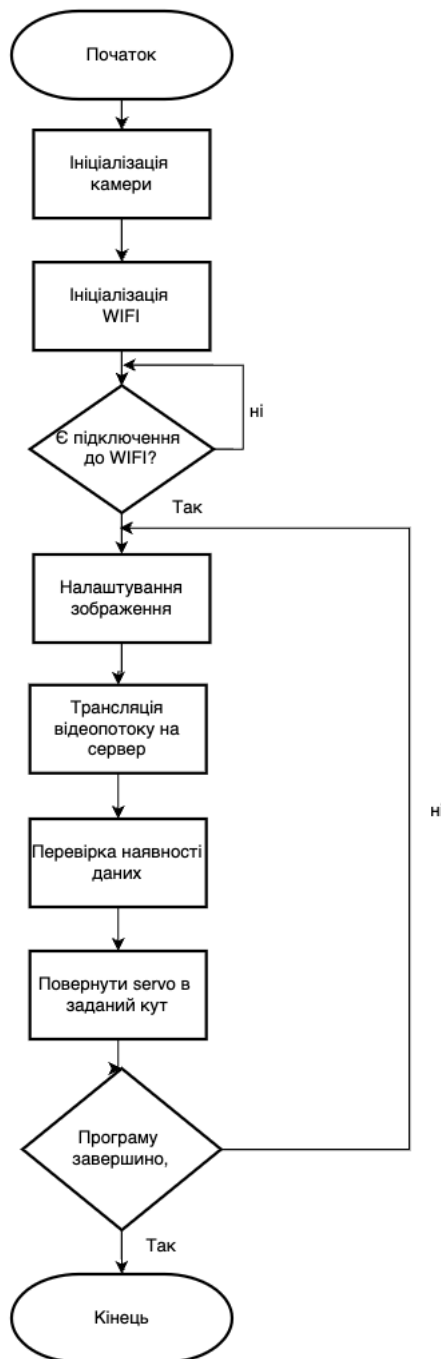
Рисунок 2.8 – Схема алгоритму роботи коду для ESP32Cam
