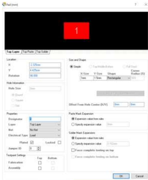
Рисунок 2.5 – Вікно властивостей контактної площадки при створенні посадочного місця компонента
