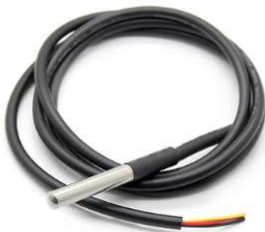
Рисунок 1.15 - Зовнішній вигляд DS18B20
