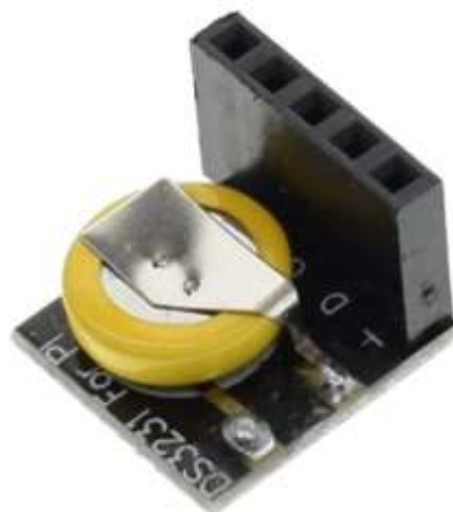
Рисунок 1.18 - Зовнішній вигляд DS3231
