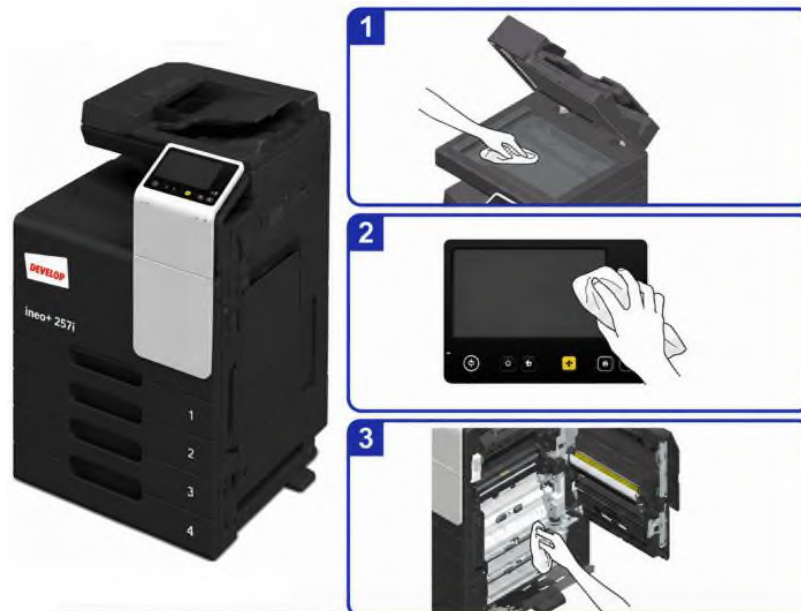
Рисунок 2.31 – Очищення скла оригіналу, панелі керування та роликів
