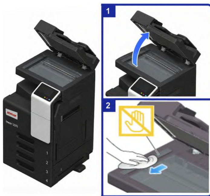
Рисунок 2.29 – Очищення щілинного скла сканування в АПД
