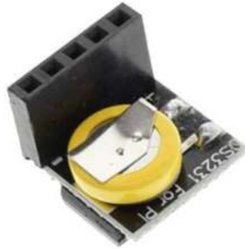
Рисунок 1.15 – Зовнішній вигляд годинника реального часу DS3231
