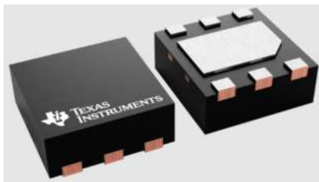
Рисунок 1.18 – Зовнішній вигляд перетворювача напруги TPS63070
