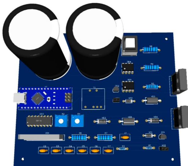
Рисунок 1.8 – Друкований вузол у 3D режимі перегляду лабораторного блока живлення з USB інтерфейсом
