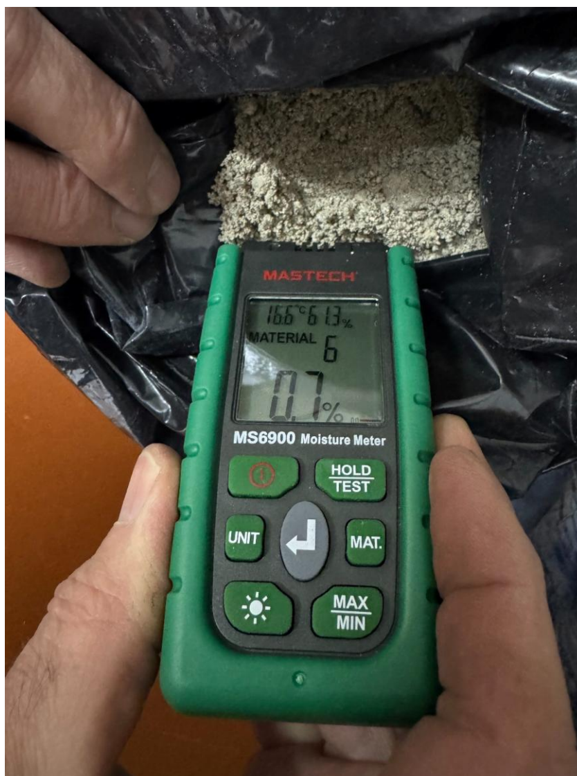
Рисунок 2.1 – Визначення вологості вапнякового відсіву вологоміром Mastech MS6900
