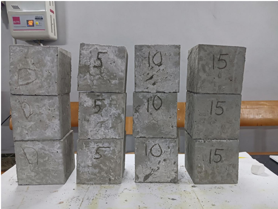
Рисунок 2.3 – Бетонні куби серій 0, 5, 10 та 15 % перед випробуванням
