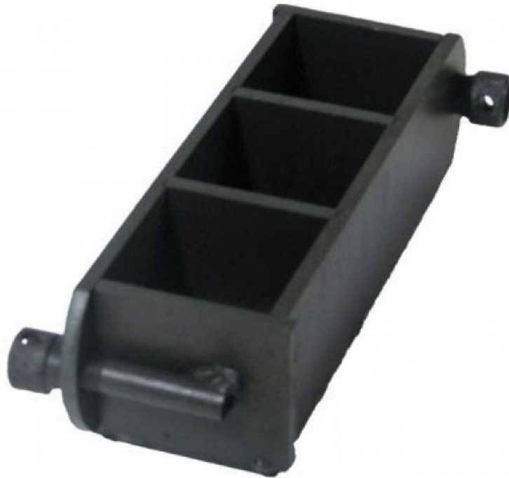
Рисунок 2.2 – Металева опалубка для одночасного формування трьох кубічних зразків
