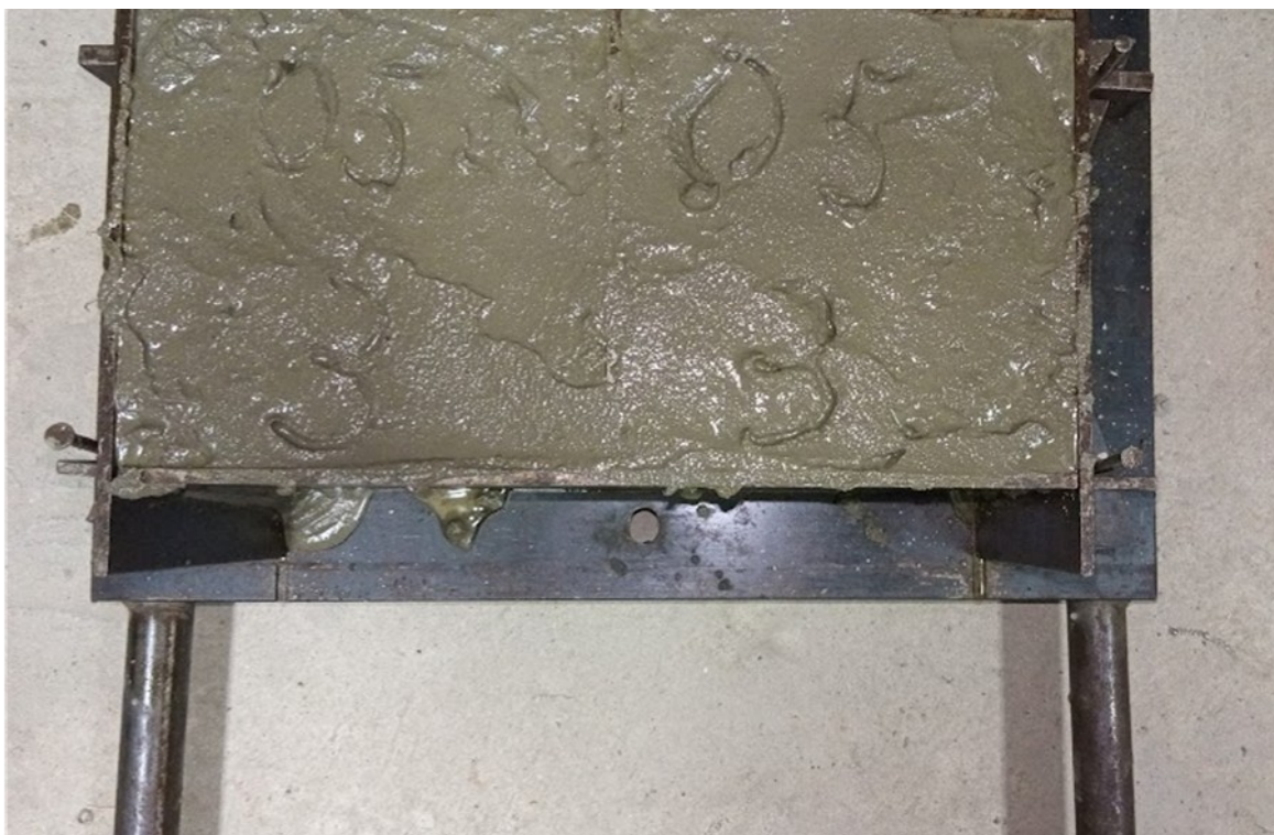
Рисунок 3.4 – Формування дослідних зразків-кубів у відповідних металевих формах
