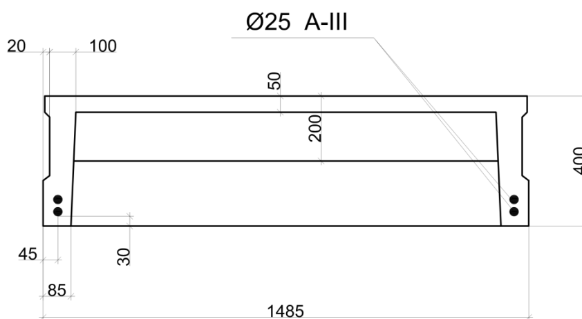
Рисунок 2.15 – Збірна залізобетонна ребриста плита та її армування
