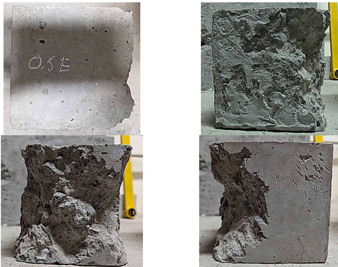
Рисунок 3.2 - Руйнування зразка серії 2 у віці 28 діб
