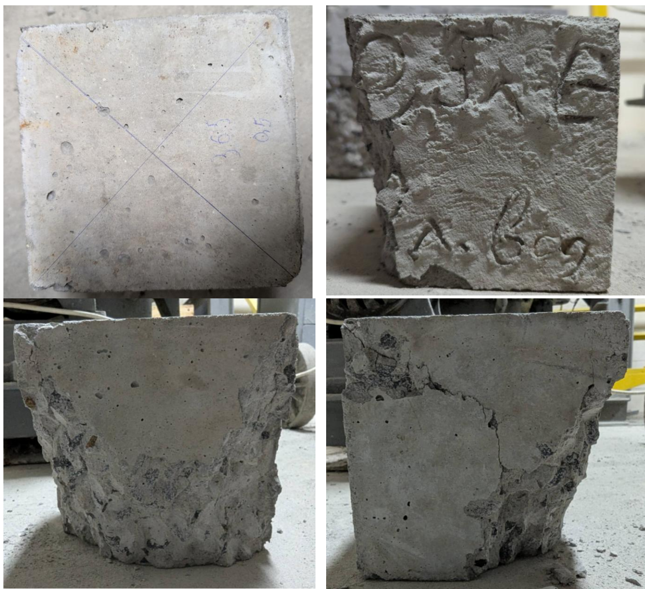
Рисунок 3.2 - Руйнування зразка серії 2 у віці 365 діб
