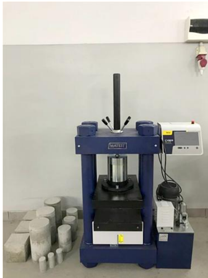
Рисунок 2.4 - Гідравлічний випробувальний прес Matest C104N [47]
