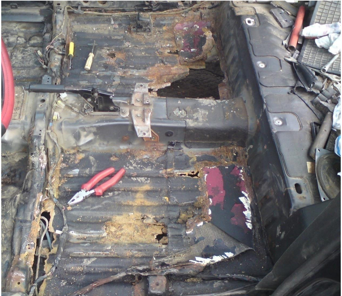
Рисунок 2.4 – Корозія днища автомобіля
