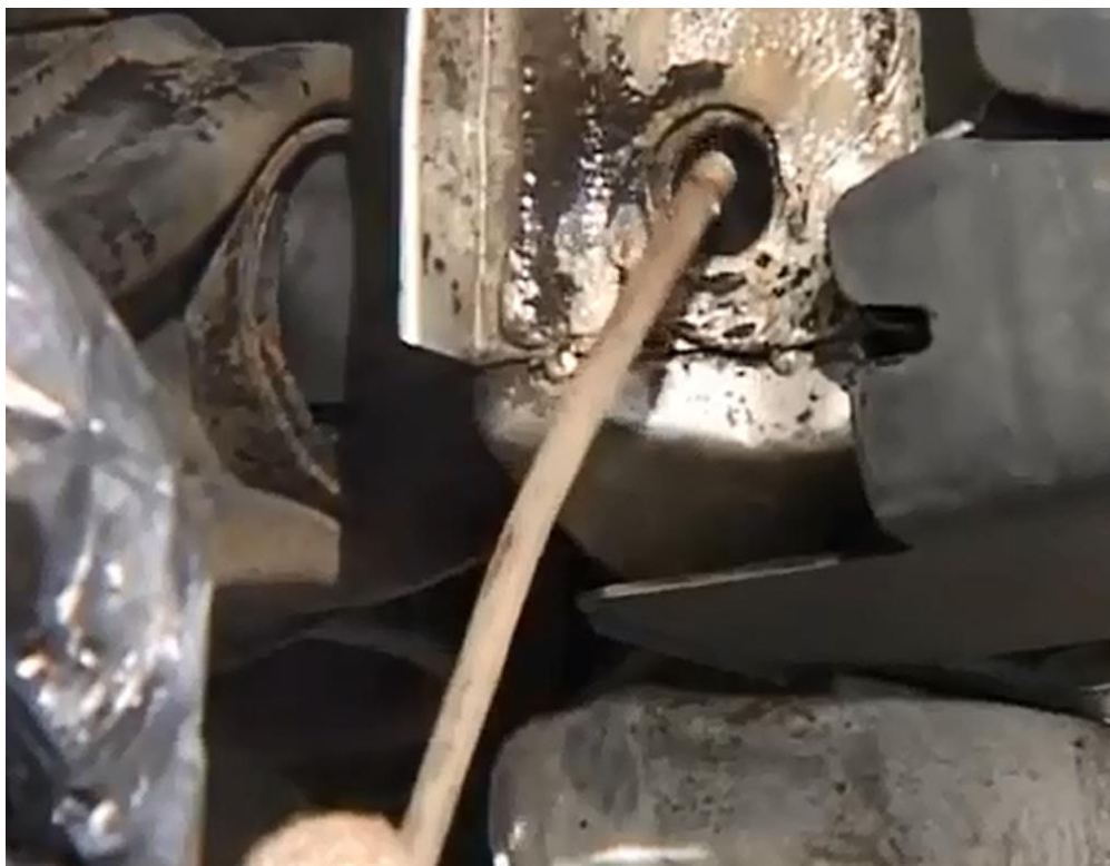
Рисунок 2.5 - Обробка прихованих порожнин внизу
