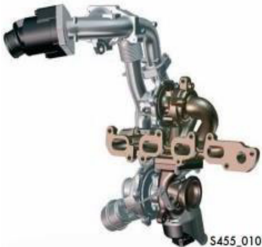
Рисунок 2.5 - Новий модуль подвійного турбонаддуву.
