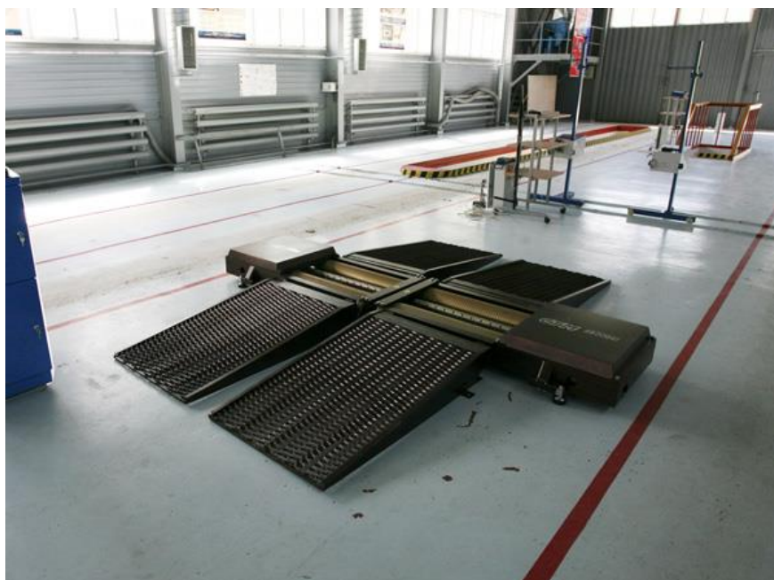
Рисунок 3.1 – Стенд для перевірки ефективності гальмівної системи
