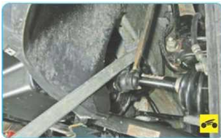
Рисунок 2.11 – Перевірка стану шарнірів стійок стабілізатора.
