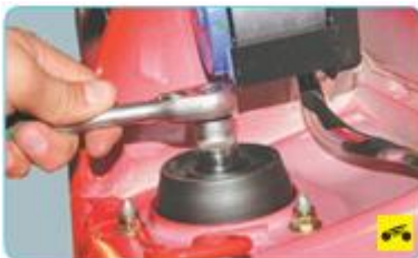
Рисунок 2.16 – Кріплення штока амортизатора
