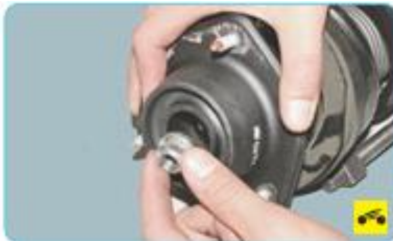
Рисунок 2.18 – Затягування гайки кріплення амортизатора
