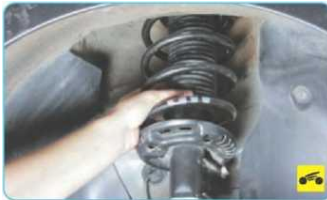
Рисунок 2.13 – Перевірка стану захисного чохла амортизаційної стійки.
