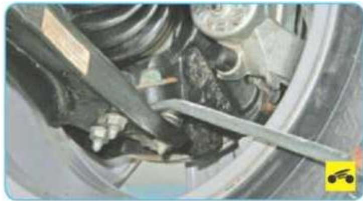
Рисунок 2.9 – Перевірка кульових опор.
