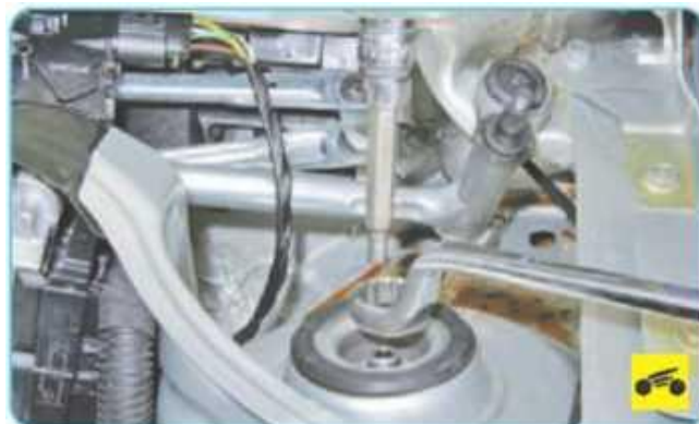
Рисунок 2.14 – Перевірка кріплення штока амортизаційної стійки.
