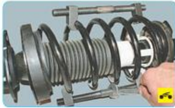
Рисунок 2.19 – Зняття пружини задньої підвіски
