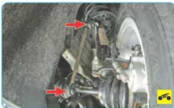
Рисунок 2.10 – Перевірка стану чохлів верхнього і нижнього шарнірів стійок стабілізатора поперечної стійкості.
