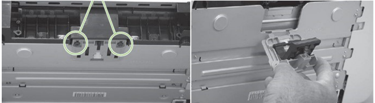
Рисунок 2.14 – Заміна гальмівної площадки
