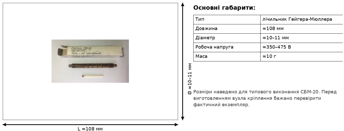
Рисунок 1.17 – Зовнішній вигляд лічильника Гейгера-Мюллера СБМ-20
