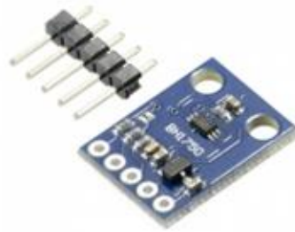
Рисунок 2.13 – Зовнішній вигляд модуля BH1750 (GY-302)
