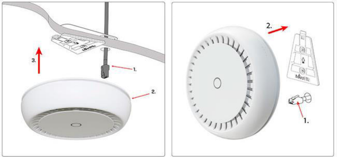
Рисунок 2.2 – Варіанти монтажу точки доступу Mikrotik RBcAPGi
