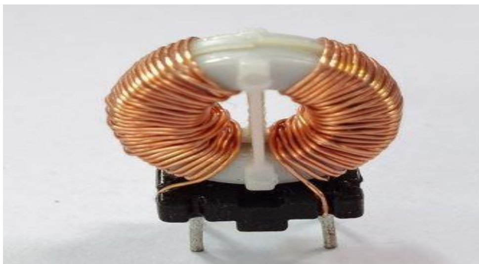
Рисунок 1.11 – Конструктивне виконання контурних безкаркасних котушок та ВЧ-дроселів
