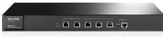
Рисунок 2.4 – SafeStream маршрутизатор TP-Link TL-ER6120
