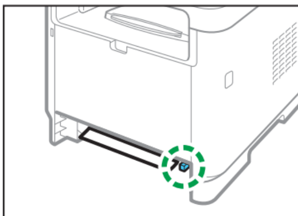
Рисунок 2.35 – Переведення блоку двостороннього друку у сервісне положення за допомогою важелю керування.
