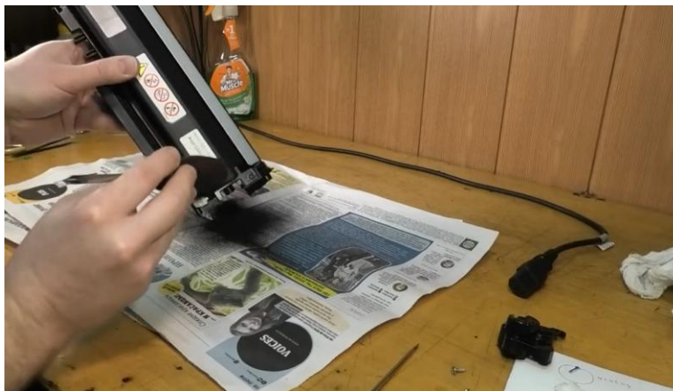
Рисунок 2.42 – очищення від старого тонера.
