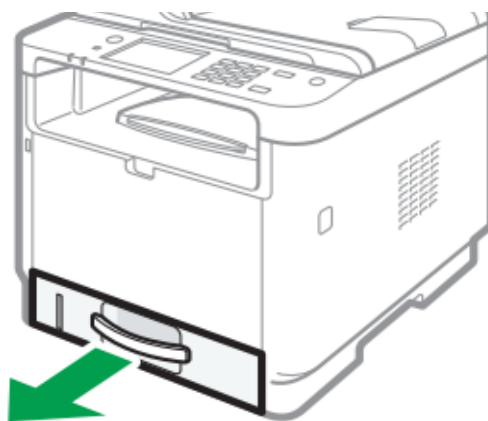
Рисунок 2.18 – Відкриття лотка з подальшим доступом до ролика, та фрикційної пластини
