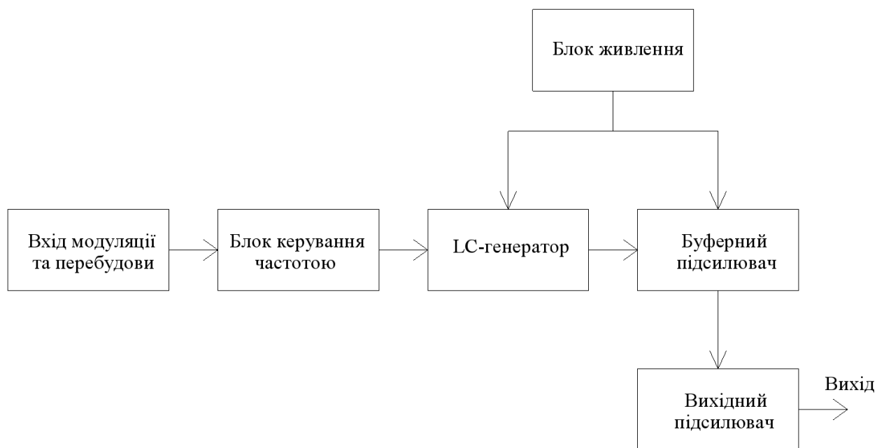
Рисунок 1.4 – Структурна схема проектного лабораторного генератора
