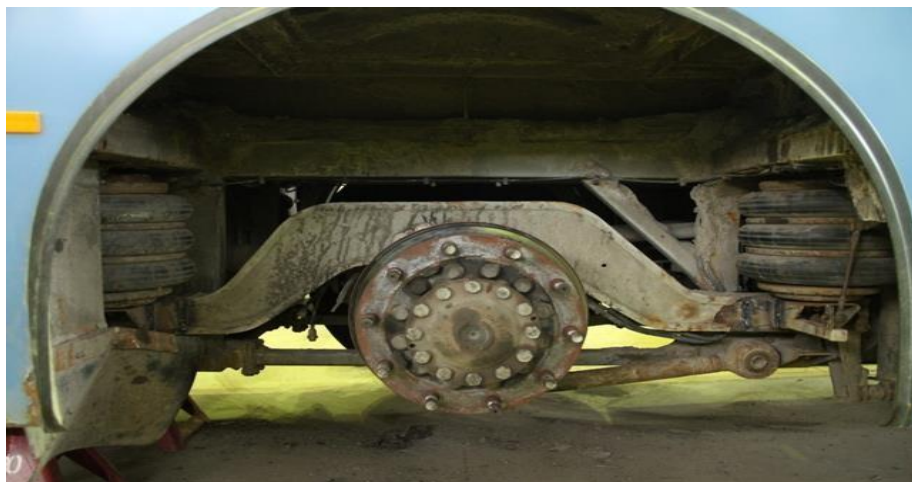
Рис. 3.1. Задня пневматична підвіска автобуса
