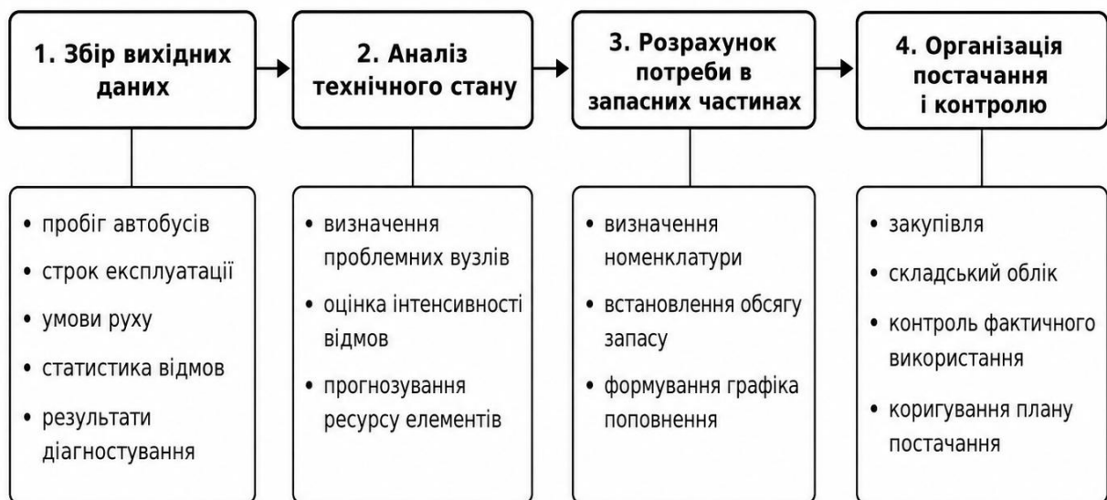
Рисунок 1.5. Схема планування потреби у запасних частинах для пневматичної підвіски
