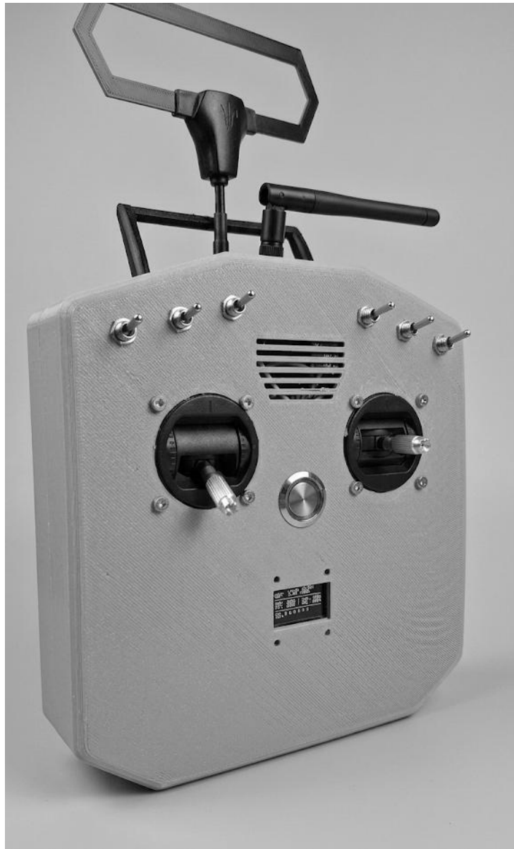
Рисунок 3.2 – Фізична реалізація та зовнішній вигляд змонтованого прототипу пульта керування
