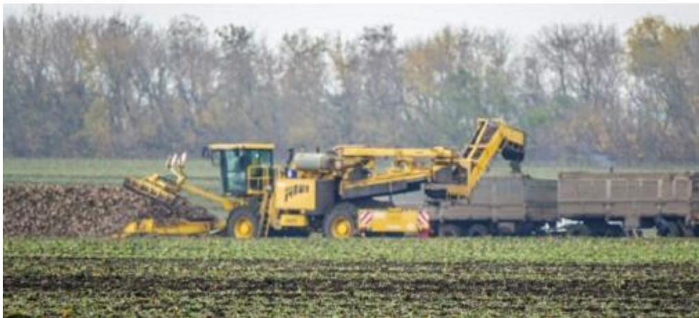
Рисунок 1.5 – Перевалочний спосіб збирання цукрових буряків
