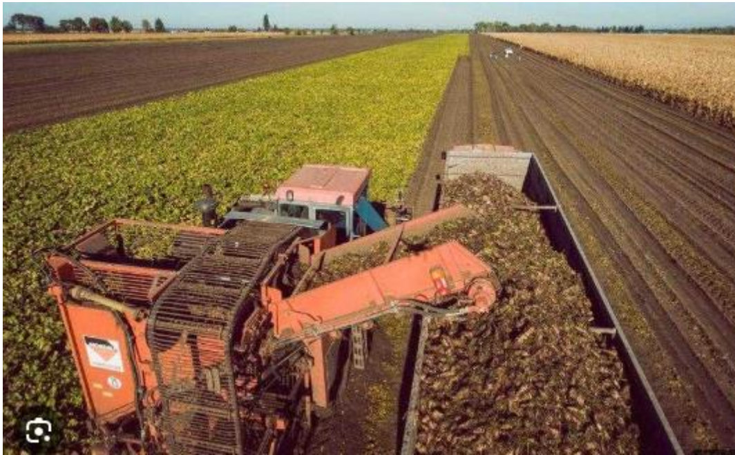
Рисунок 1.4 – Поточковий спосіб збирання цукрових буряків
