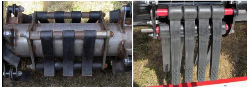
Рисунок 1.8 – Гичкозрізувачі для цукрових буряків від компанії Amity Technology (США)
