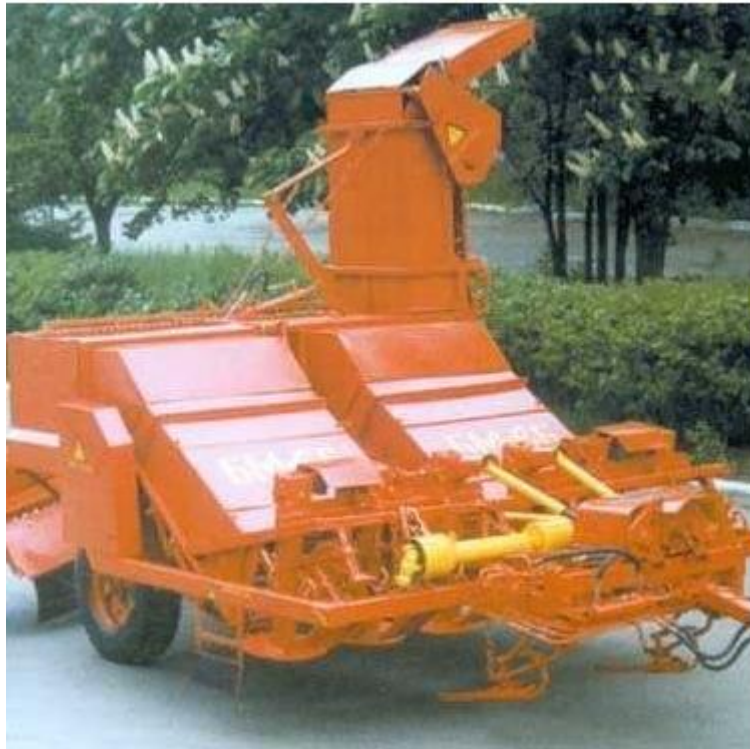
Рисунок 1.7 – Гичкозбиральна машина типу БМ-6
