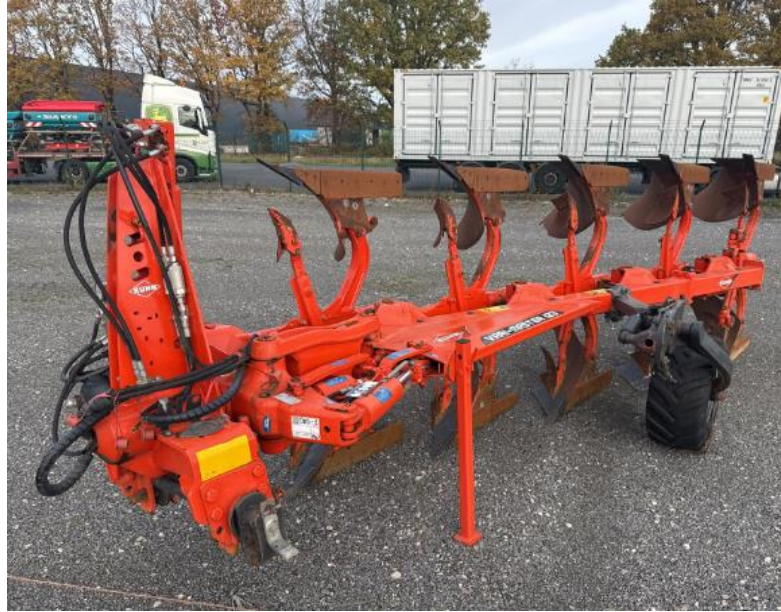
Рисунок 2.4 – Плуг KUNH Vari-Master зі змінною шириною [19]
