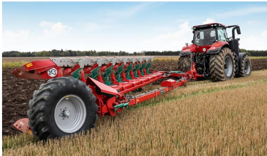
Рисунок 2.3 – Напівнавісний оборотний плуг Kverneland 6300 S VARIOMAT зі змінною шириною захвату (6–8 корпусів) [18]
