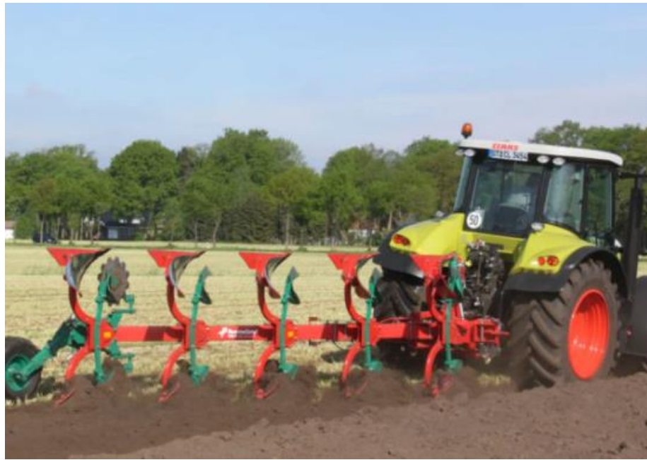
Рисунок 2.2 – Оборотний навісний плуг Kverneland Variomat у роботі [17]
