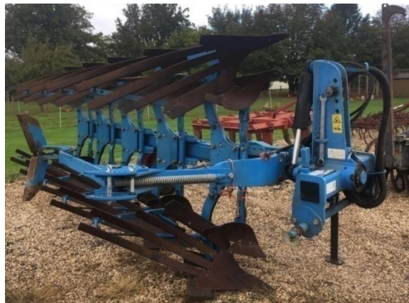
Рисунок 2.5 – Плуг Lemken VariOpal з регульованою шириною захвату [21]
