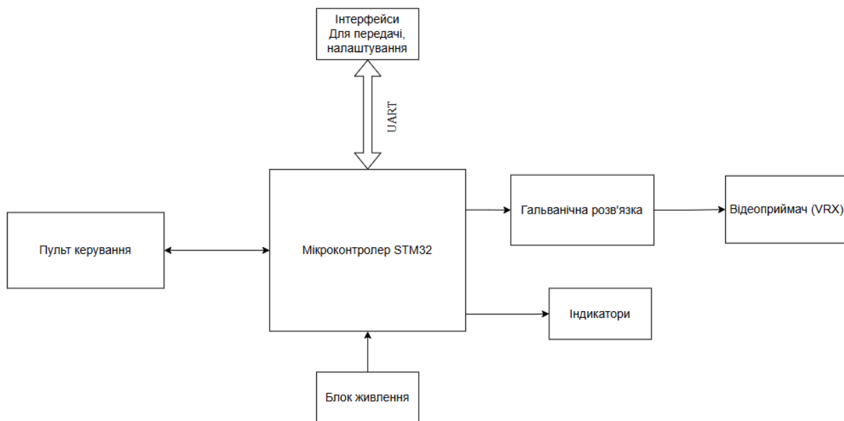
Рисунок 2.1 – Структурна схема вбудованої комп'ютерної системи перемикання відеочастот
