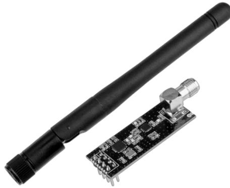
Рисунок 2.6 – Зовнішній вигляд радіомодуля NRF24L01+
