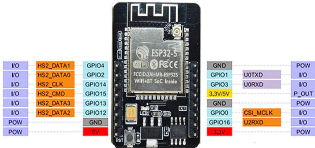
Рисунок 2.3 – Призначення пінів модуля ESP32-CAM
