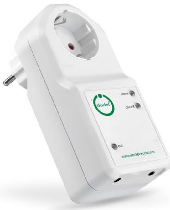
Рисунок 1.3 – Розумна GSM розетка iSocket
