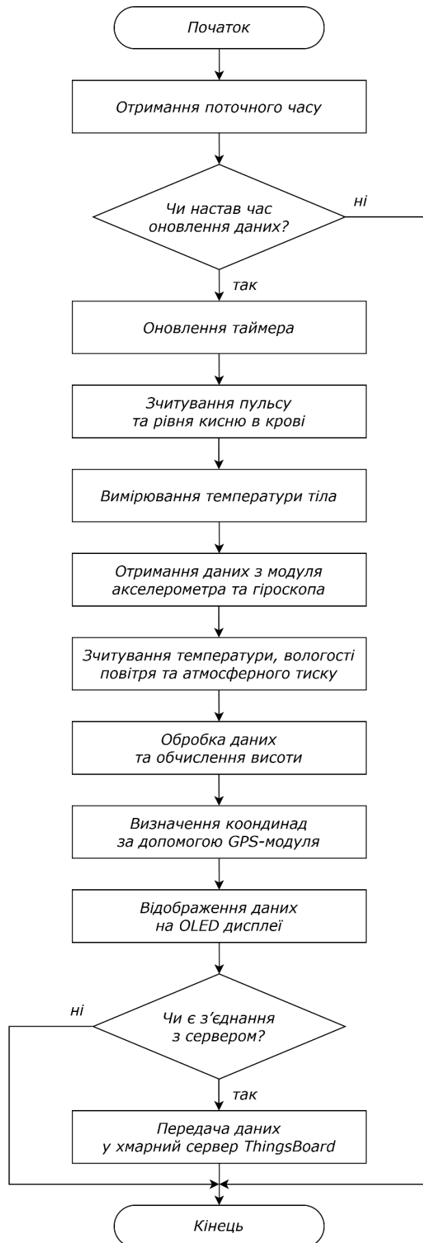
Рисунок 3.1 – Блок-схема алгоритму роботи основного циклу програми у системі моніторингу активності альпініста
