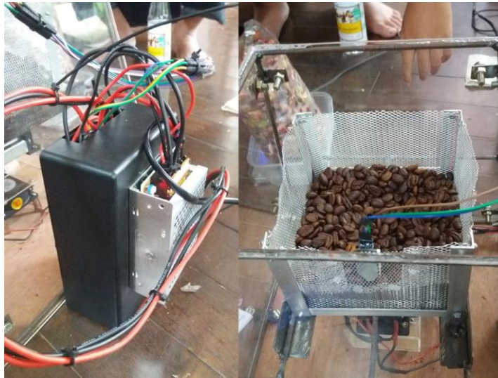
Рисунок 1.3 – Система моніторингу умов під час сушіння кавових зерен
