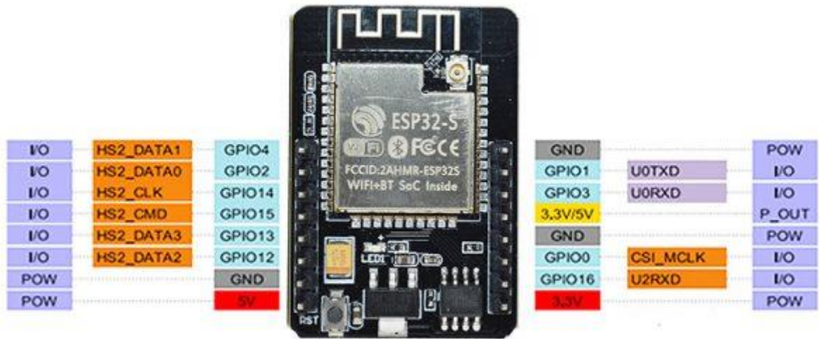
Рисунок 2.3 – Функції виводів платформи ESP32-CAM
