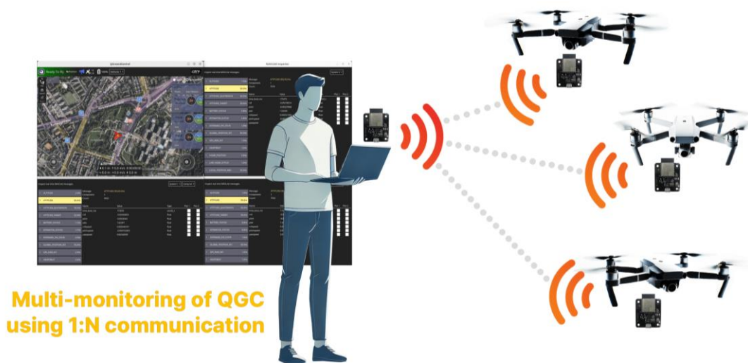
Рисунок 1.3 – Система Mapple для передачі даних польоту між БПЛА і наземною станцією
