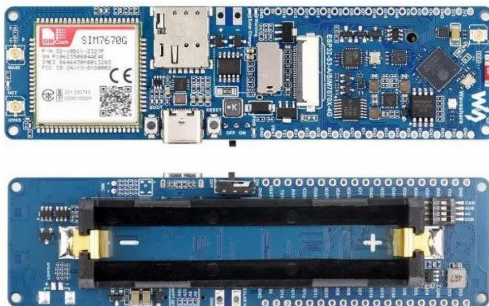
Рисунок 2.2 – Платформа мікроконтролера ESP32-S3 SIM7670G
