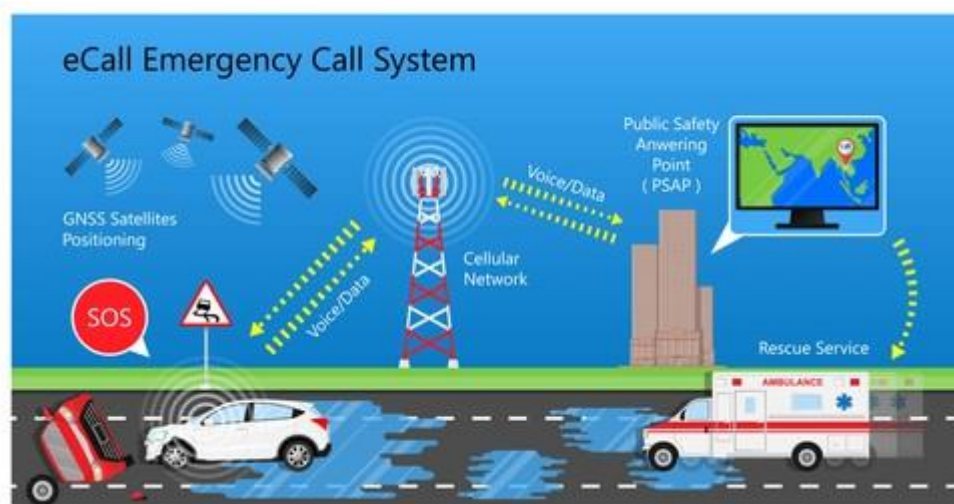
Рисунок 1.1 – Європейська система автоматичного виклику допомоги eCall
