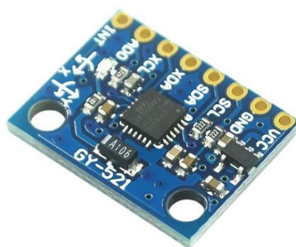
Рисунок 2.3 – Модуль акселерометра і гіроскопа MPU-6050
