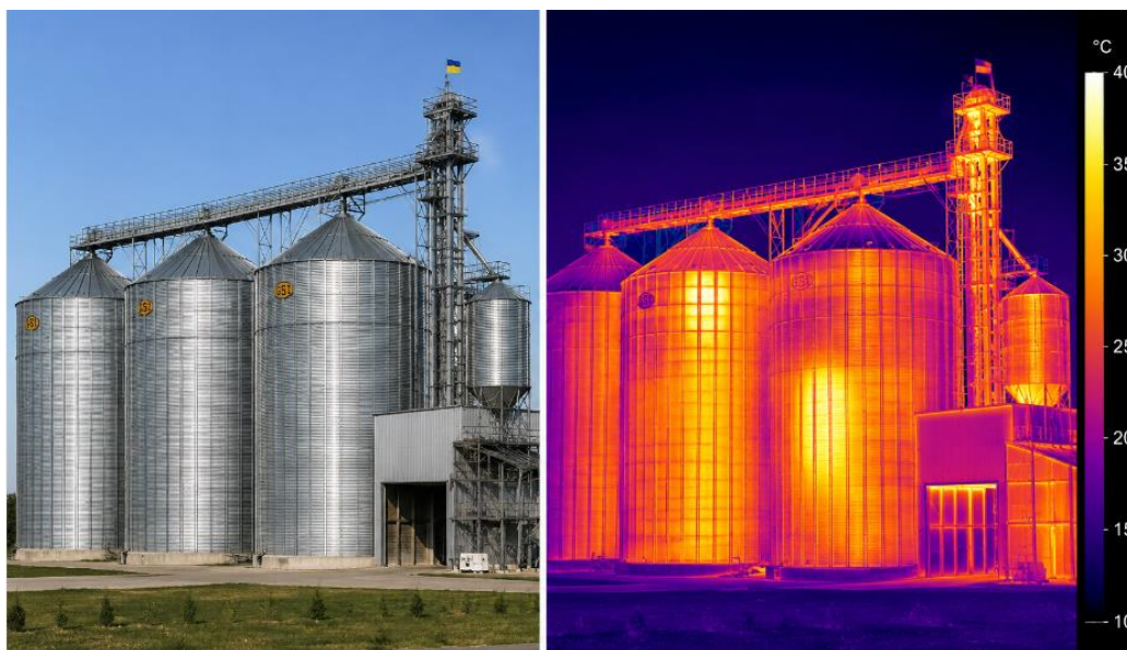
Рисунок 3.10 – Фотографії елеватора у видимому та тепловому спектрі
