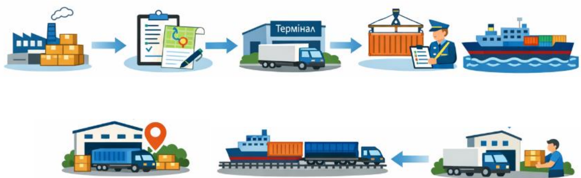
Рисунок 1.2 – Схема мультимодальних перевезень: вантажовідправник попереднє планування маршруту та укладання єдиного договору автомобільне перевезення до транспортного терміналу перевантаження та митне оформлення магістральне перевезення (залізничне або морське) логістичний центр у пункті призначення доставка автомобільним транспортом вантажоодержувачу
