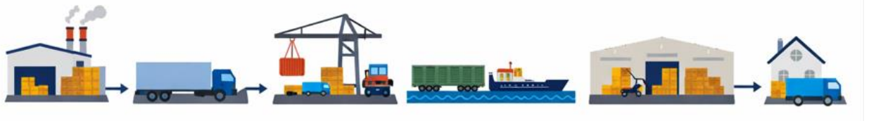
Рисунок 1.1 – Схема мультимодальних перевезень: вантажовідправник автомобільне перевезення до терміналу перевантаження у транспортному вузлі залізничне або морське перевезення (основна ділянка) логістичний центр у пункті призначення автомобільна доставка вантажоодержувачу
