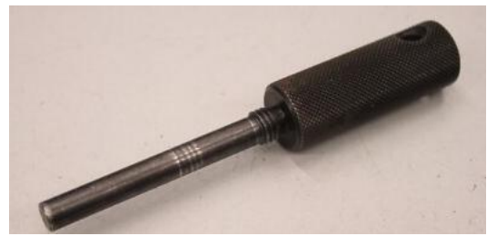
Риунок 3.1 – Фіксатор положення ВМТ (пристосування Mot.1489)
