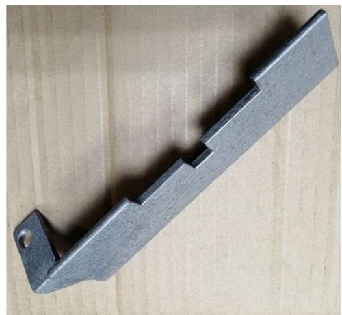
Рисунок 3.2 - Фіксатор розподільчих валів (пристосування Mot.1496)
