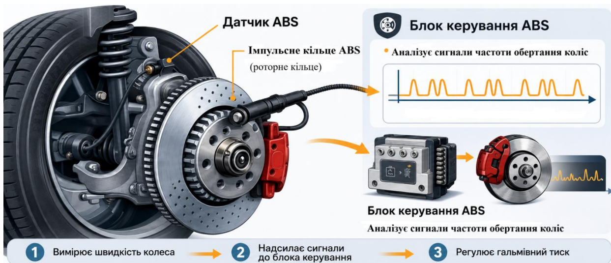
Рисунок 3.2 – Принцип функціонування датчика швидкості системи ABS
