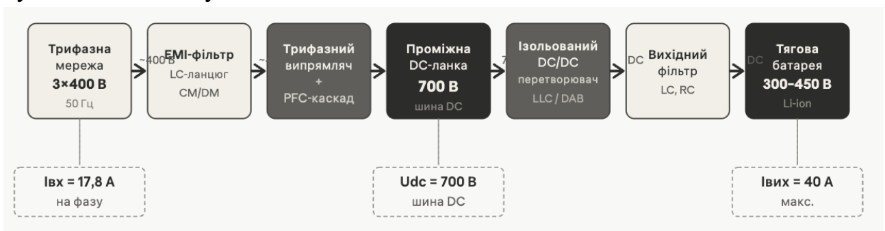
Рисунок 2.3 – Розрахункова структура силової частини бортового зарядного пристрою
