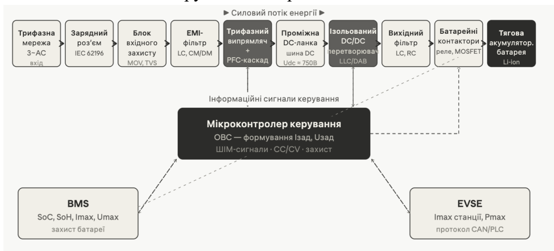
Рисунок 2.2 – Структурна схема бортового зарядного пристрою електромобіля
