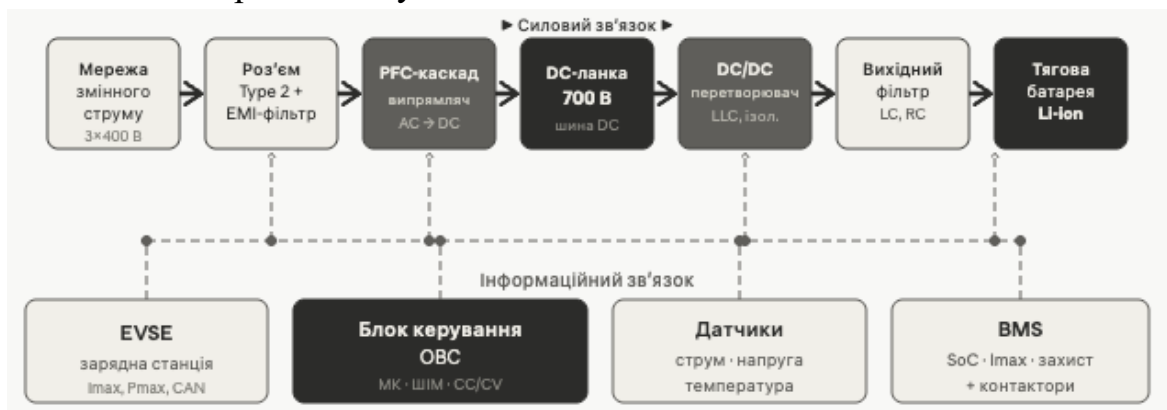
Рисунок 3.2 – Силові та інформаційні зв'язки в структурі бортового зарядного пристрою
