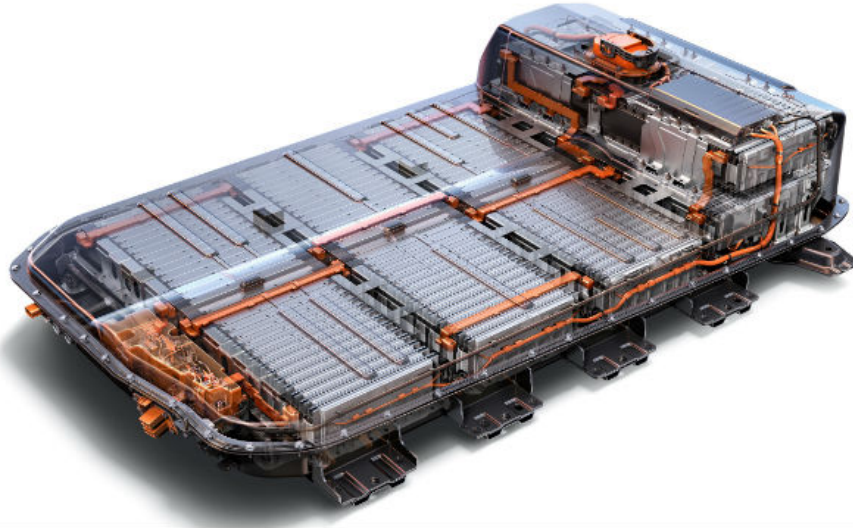
Рисунок 1.6 – Загальна структура тягової акумуляторної батареї електромобіля
